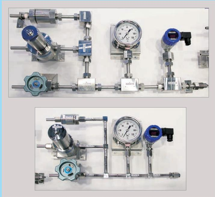
高圧水素配管の溶接接合
