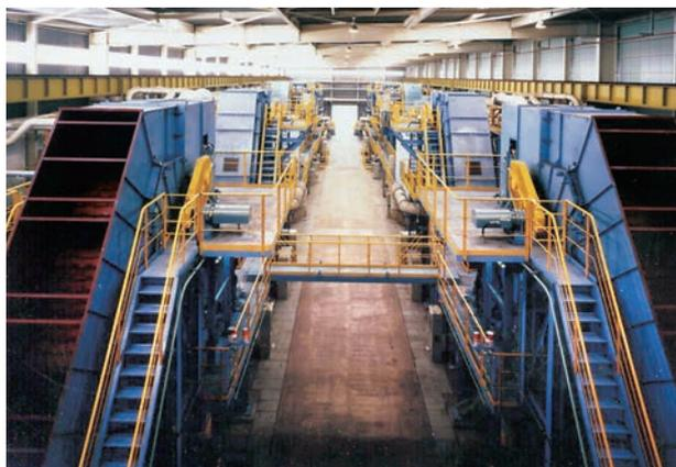
君津製鉄所のプラスチックリサイクル設備
