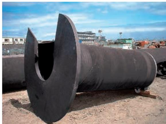
日本製鉄のNSエコパイル®は、鋼管杭の先端にらせん状の羽根を取り付けた形状をしており、杭本体に回転力(トルク)を付与し、羽根の推進力を利用して地盤に貫入していく工法。施工時に排土がなく、狭隘地での施工を可能にする。構造的には先端の羽根の拡底効果により、大きな鉛直支持力と引抜き支持力を有しており、軟弱地盤に適している。鋼管杭基礎であるため、大きな変形性能を持ち、耐震性にも優れている。
