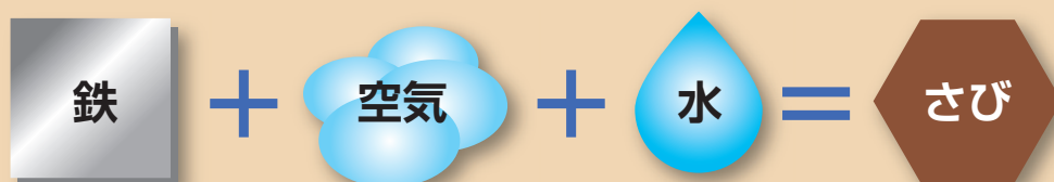
図1 さびのメカニズム
