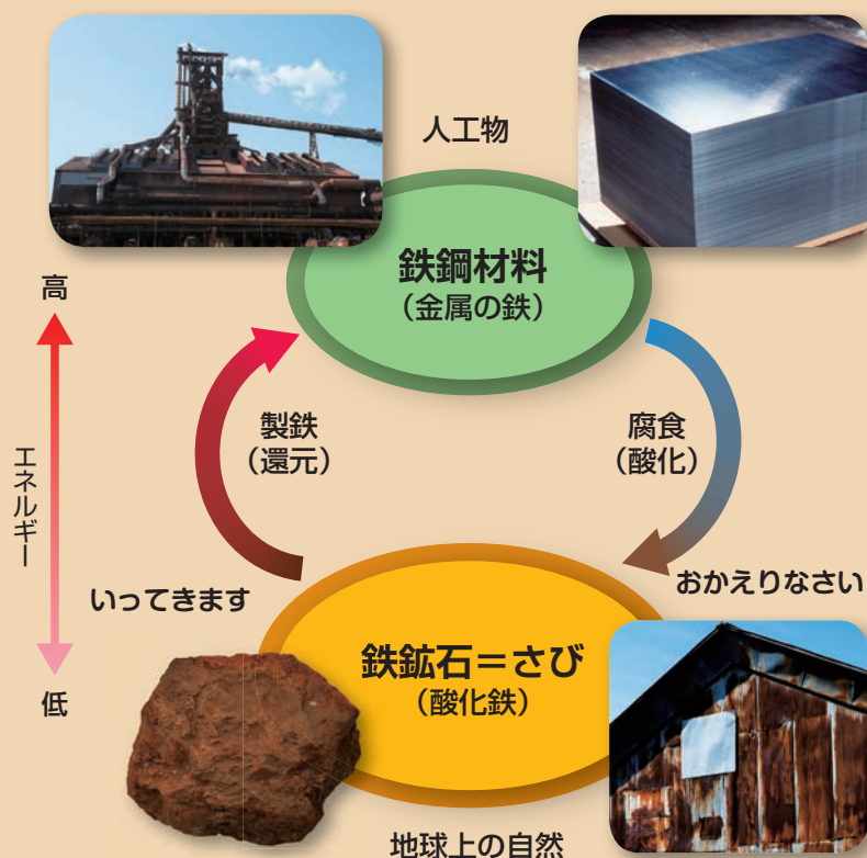
図2 鉄鉱石から鉄鋼材料、鉄鋼材料からさびへのダイアグラム
