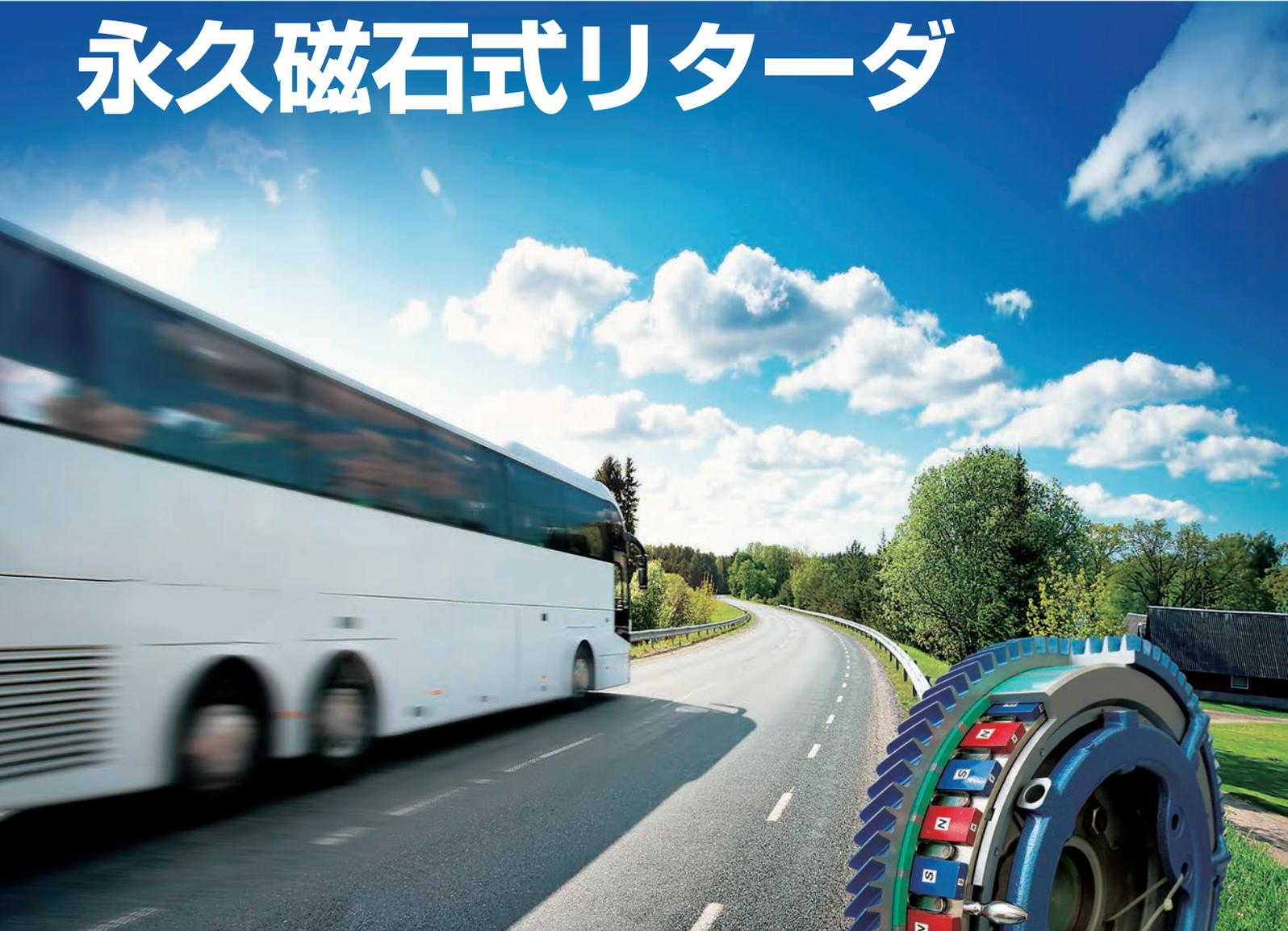
「リターダ」という言葉をご存知でしょうか？ トラックやバスが長い下り坂などで減速するとき、リターダと呼ばれる補助ブレーキが活躍しています。新日鉄住金は1990年に世界で初めて「永久磁石式リターダ」を開発し、現在では大型観光バスや中大型トラックにおいて、他方式を含むリターダの国内シェアで80%超を誇っています。新日鉄住金の永久磁石式リターダは、絶え間ない技術革新でモデルチェンジを重ねて(図1)性能に磨きをかけ、トラックやバスの安全走行に貢献しています。
