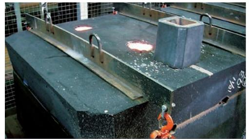
①溶鉄鑄造工程 型に鉄を流し込んで部品を鑄造し、その後機械加工を行い、組み立ての準備をする。
