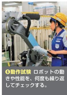
⑧動作試験 ロボットの動きや性能を、何度も繰り返してチェックする。
