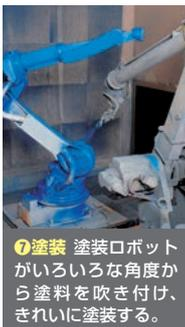
⑦塗装 塗装ロボットがいろいろな角度から塗料を吹き付け、きれいに塗装する。
