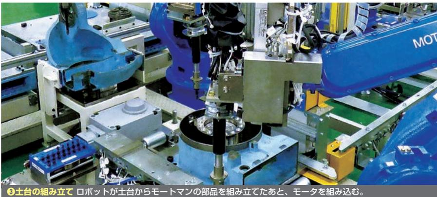
⑥土台の組み立て ロボットが土台からモトマンの部品を組み立てたあと、モータを組み込む。
