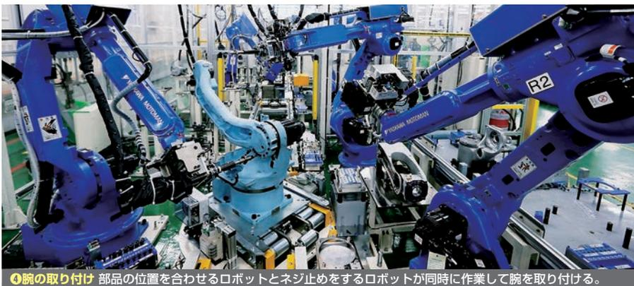
⑤腕の取り付け 部品の位置を合わせるロボットとネジ止めをするロボットが同時に作業して腕を取り付ける。
