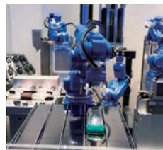
超小型ロボットとターンテーブルが協調しながらミニカーをスピーディーに組み立てる。
