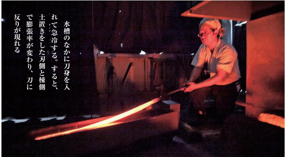
水槽のなかに刀身を入れて急冷する。すると、土置きをした刃側と棟側で膨張率が変わり、刀に反りが現れる
