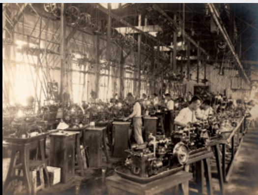
ピニオン自動旋盤機の開発と懐中時計の量産化(1909(明治42)年)
