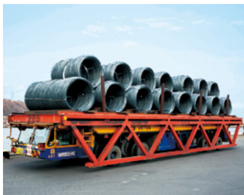
キャリアパレットカーと呼ばれる特殊車両は95トンもの鋼材を一度に輸送船へ運べる。
