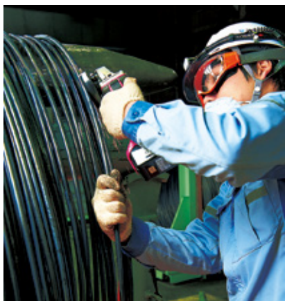
線材コイルの解体検査。万ーキズが見つかったとき、どの工程に起因しているのか、製造履歴をたどり、品質の改善につなげている。
