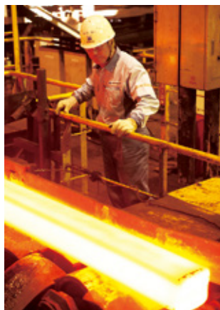
鋼片をどう加熱するかでも品質が左右されるため、現場のわずかな変化も見逃さない。
