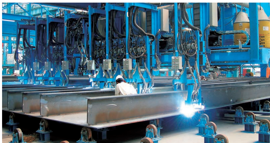
写真1 自動ロンジ溶接装置
