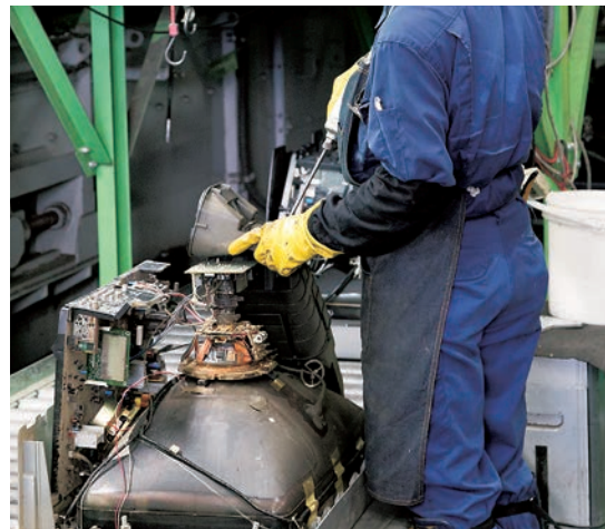
ブラウン管テレビはパネルガラスとファンネルガラスに分割してガラスを別々に回収
