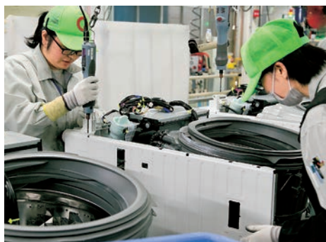
ドラム式洗濯機の本体組立工程
