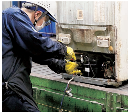
冷蔵庫のコンプレッサから冷媒フロンを回収
