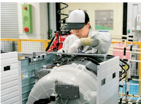
ドラム式洗濯機の本体組立工程
