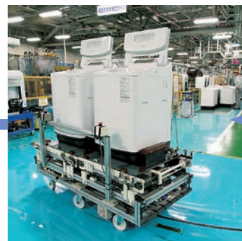
自動搬送台車で本体組立工程に運ばれる縦型洗濯機ボディ
