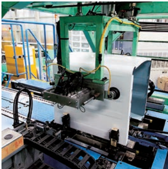
縦型洗濯機のボディ形状に加工され た塗装鋼板
