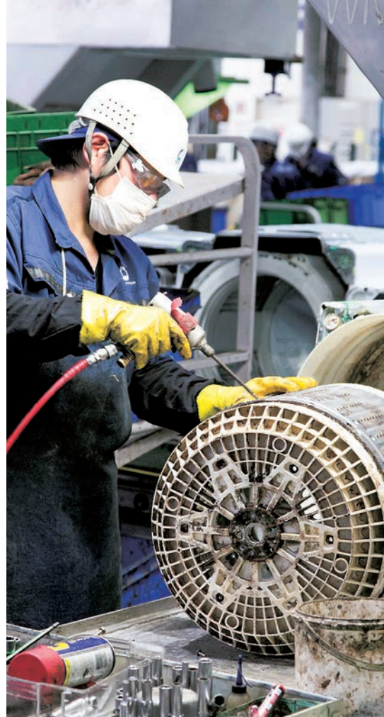
洗濯機からステンレス槽を取り外す
