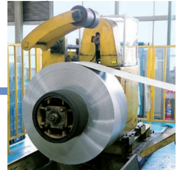
コイルが解かれていく塗装鋼板
