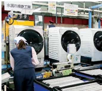
本体組立後のブロック検査
