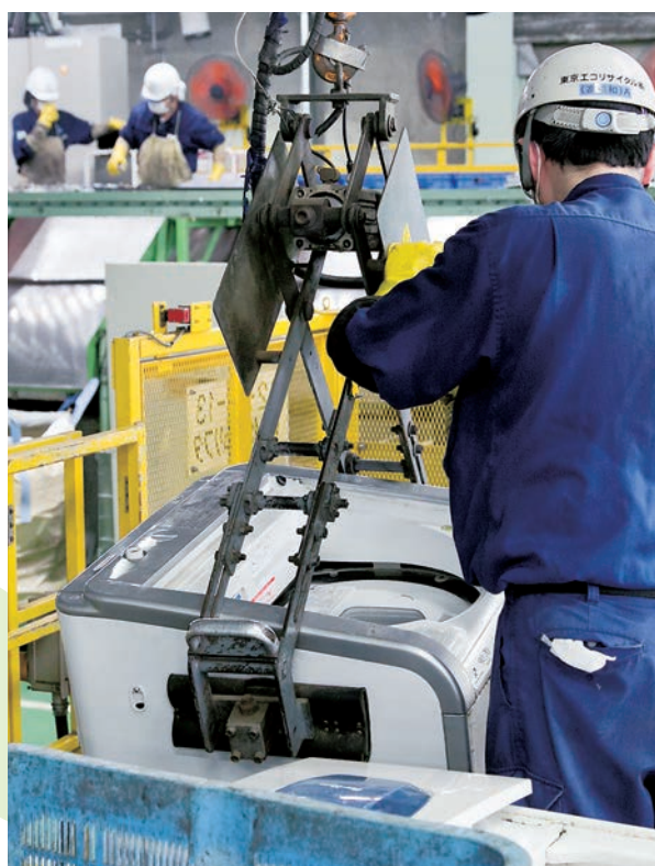
筐体を持ち上げ共通破砕機へ送る
