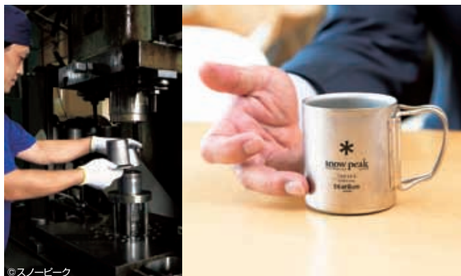
チタンマグカップは燕三条で培われた金属加工の技術力で深絞りを実現している
