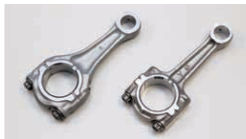
チタンコンロッド(左)と鉄製コンロッド 新日鉄住金独自のチタン合金は、従来型汎用チタン合金と同等の強度を持ちながら、熱間加工性と切削加工性に優れている。コンロッドの軽量化でエンジン全般の軽量化と馬力ロス低減に貢献した。
