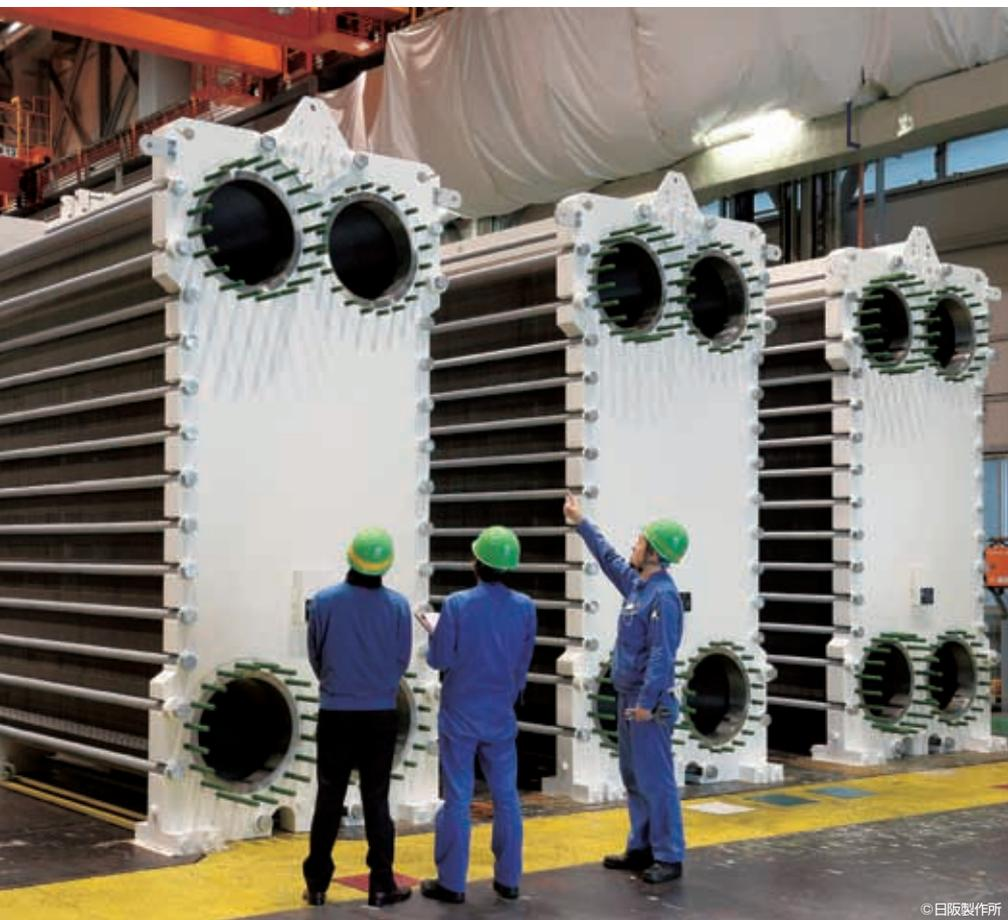
超大型プレート式熱交換器 SUPER JUMBO
