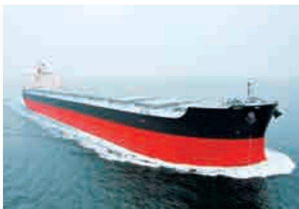
NSafe®-Hull を適用する同型のばら積み運搬船(20万6,600 載貨重量トン型)
