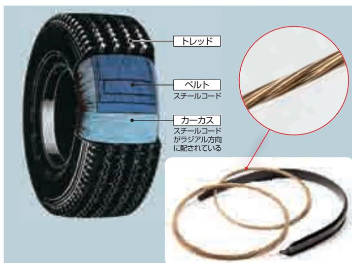
タイヤの補強材として使われるスチールコード。直径0.2〜0.3ミリの細線を撚り合わせたコードを、ゴムなどと共に加工してタイヤをつくる
