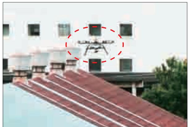
新日鉄住金君津製鉄所(東京地区)で、工場建物の屋根の劣化状況調査試験を実施。飛行状況(写真上)と撮影映像
