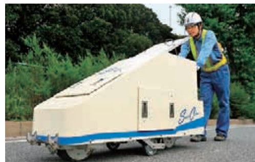
埋設鋼管塗覆装損傷検査(スーパーコーディンス)
