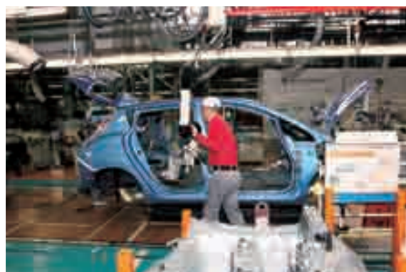
組み立てライン上で内装部品を取り付けていく
