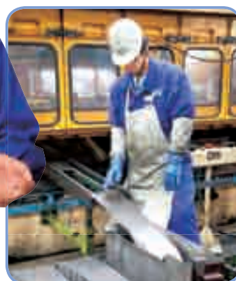
製品サイズに合わせて高速で打ち抜く
