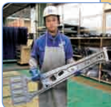
複数の金型をセットした 大型トランスファープレスで 連続加工される製品
