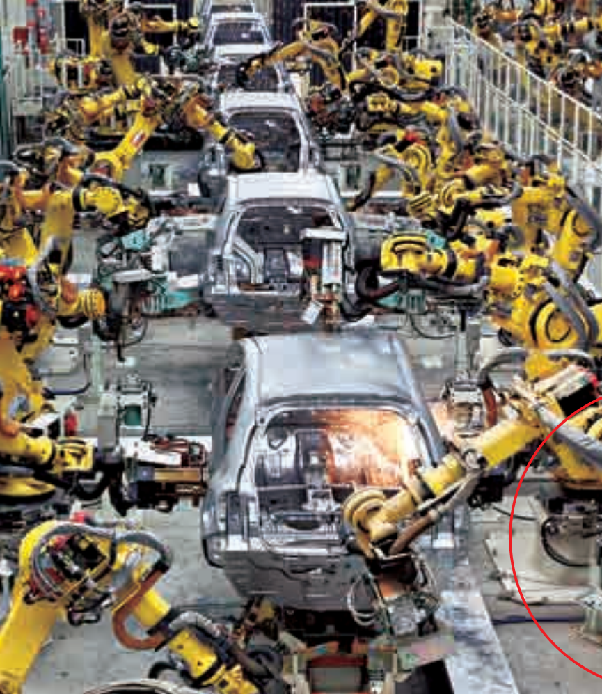
プレス加工されたパネルを溶接ロボットでつなぎ合わせる
