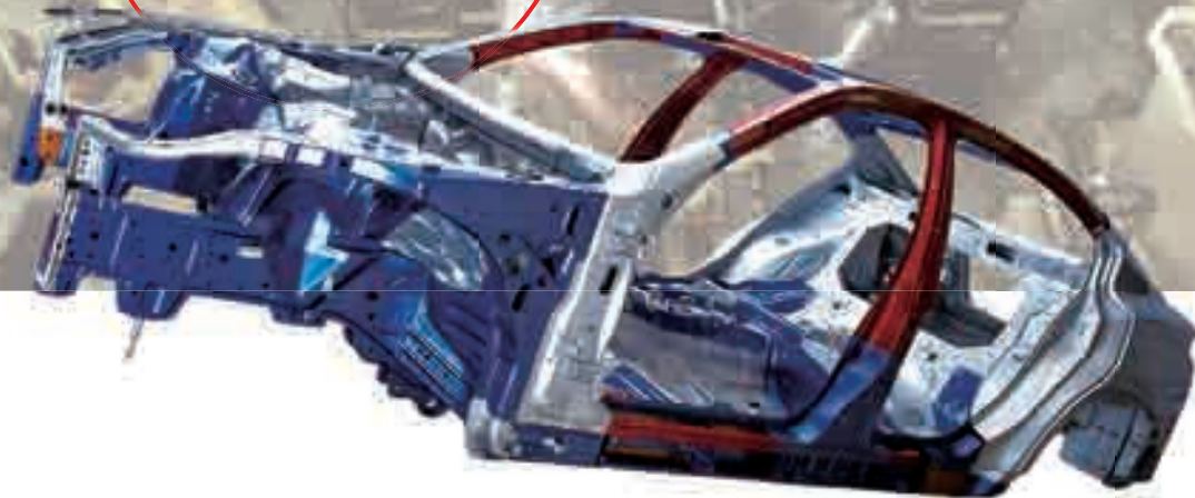
世界で初めて1.2ギガパスカル級高成形性超ハイテン(赤色の部分)が採用された自動車の骨格
