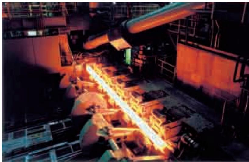
高級鋼管の製造拠点である和歌山製鉄所に設置。加熱した棒状の材料を交叉穿孔機で中空の管にし、その後延伸圧延する。
