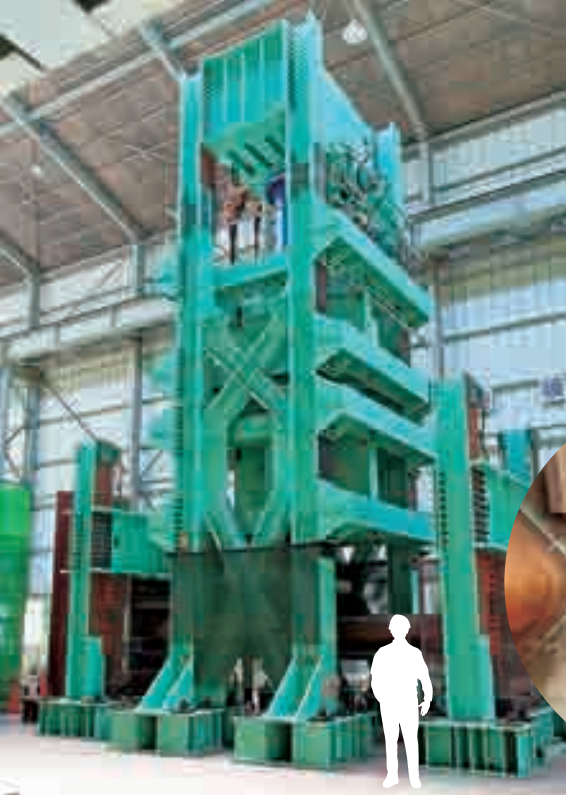
世界最大級の大型構造物交番載荷装置 (荷重 1,000 トン、載荷ストローク 1.2 メートル)
