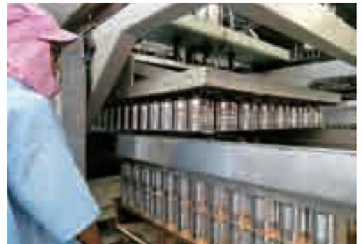
パイン缶を磁石でパレット積みし次の工程へ
