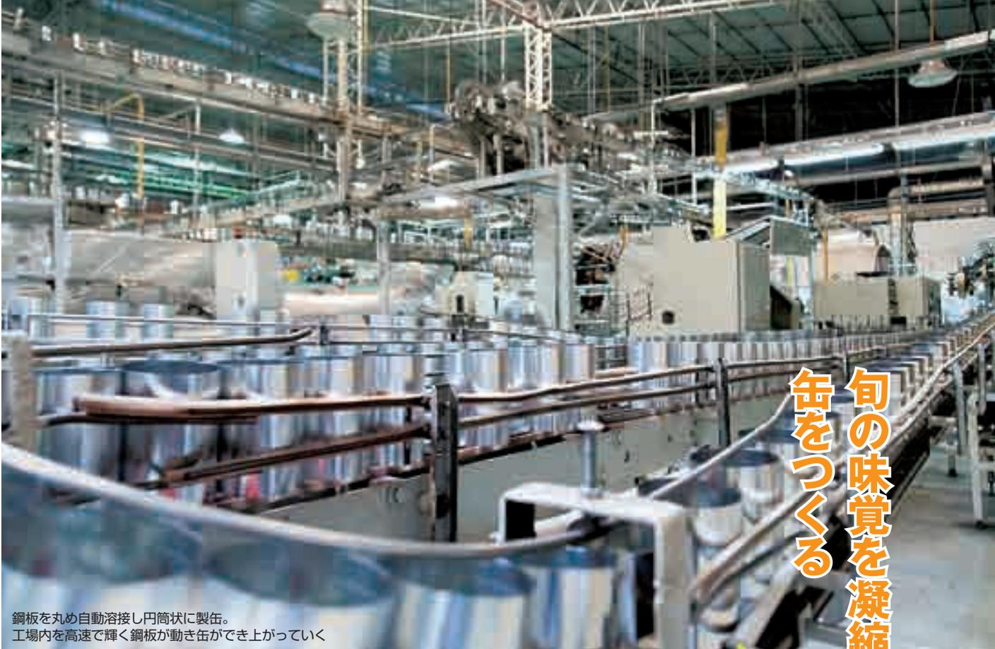
鋼板を丸め自動溶接し円筒状に製缶。
