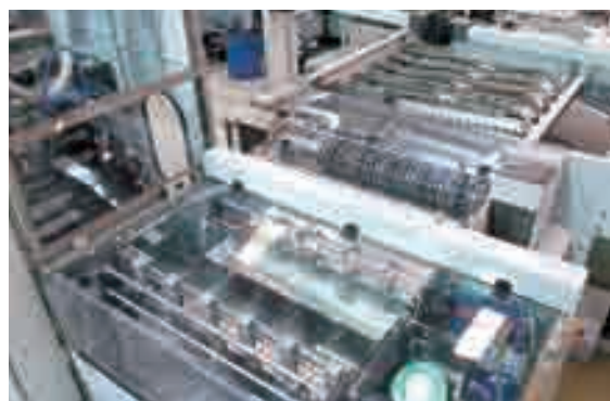
打ち抜かれていく蓋部の鋼板（上） 短冊状に切断されていく缶胴部の鋼板（下）
