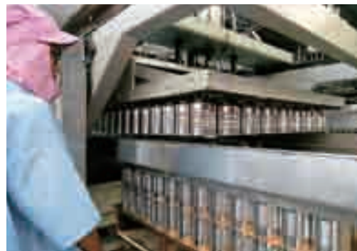
パイン缶を磁石でパレット積みし次の工程へ
