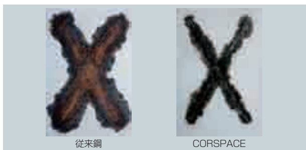
CORSPACE™のさび進行抑制効果の例。塗装試験片にクロスカットを入れて加速腐食試験後、剥離塗膜を除去したもの。
