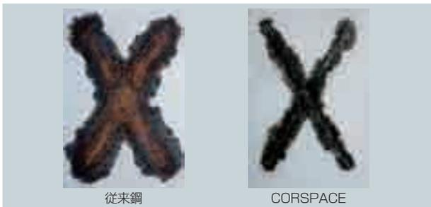
CORSPACE<sup>™</sup>のさび進行抑制効果の例。塗装試験片にクロスカットを入れて加速腐食試験後、剥離塗膜を除去したもの。
