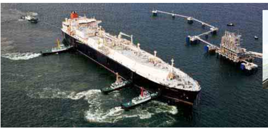
タグボードを使って着岸する大型タンカー
