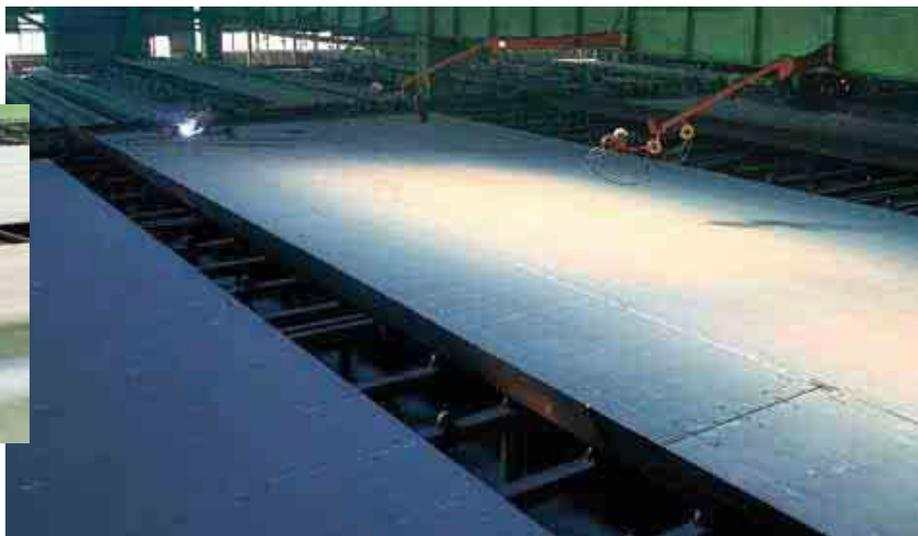
船の大型パネルを切り取れるように、厚板をつなぎ合わせて大きな板が作られていく。大型船1隻の溶接部の長さは東京・鹿児島間の直線距離に相当する約1,000kmにも及ぶ。
