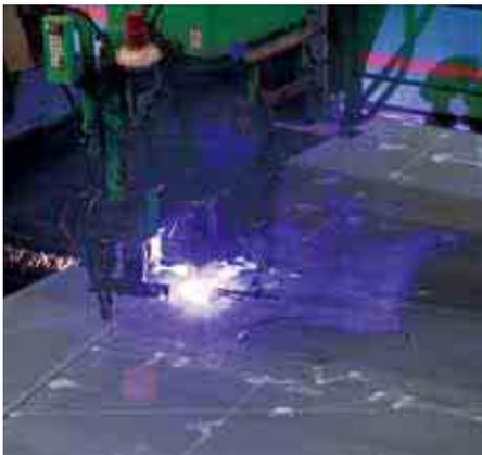
コンピュータ数値制御のNC自動切断機で厚板が図面通りのサイズに切り抜かれていく。
