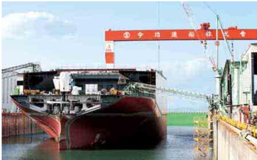
進水式を終えて船がドックを出ると、ドックから水が抜かれ、すぐ次の船のブロックが建造されていく。
