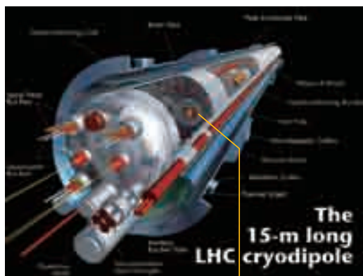
粒子加速器断面模式図(資料提供: CERN)
