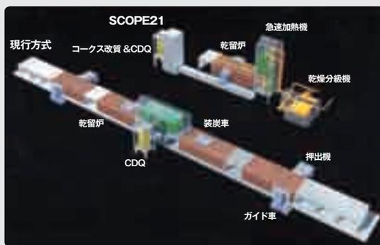
SCOPE21は、原料炭の事前急速加熱などの革新的技術開発により、コークスの品質向上、コークス製造時間の大幅短縮を図り鉄鋼業の国際競争力向上を実現する、世界初の技術。(財)石炭利用総合センターと日本鉄鋼連盟との共同研究として実施された。
