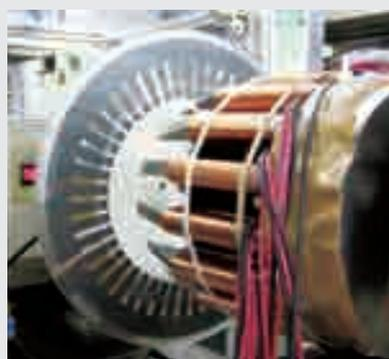
モータ回転鉄損シミュレータ
