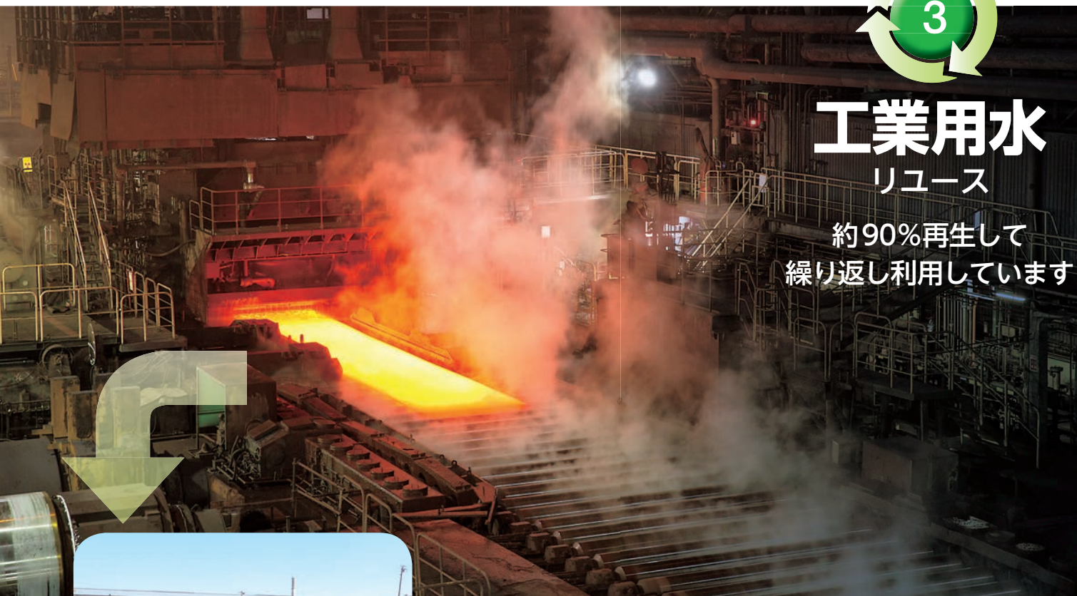
熱延工程 冷却時に水が使われ、水蒸気が立ち上っている。
