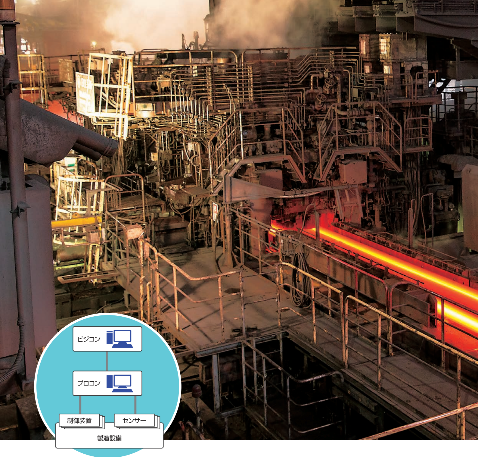
図1 製鉄所の計算機システムの仕組み
