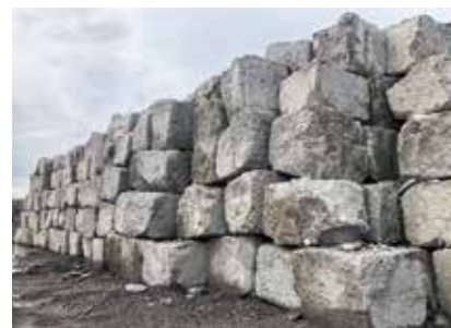
⑤ ビバリーロック 転炉系製鋼スラグと高炉スラグ微粉末などからつくった石で藻類・生物着生の基質材。
