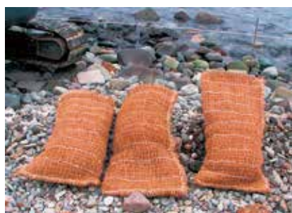
① ビバリーバッグ(ビバリーユニット) 転炉系製鋼スラグと人工腐葉土を混ぜ合わせた腐植酸鉄供給ユニットを海岸線に埋設。
