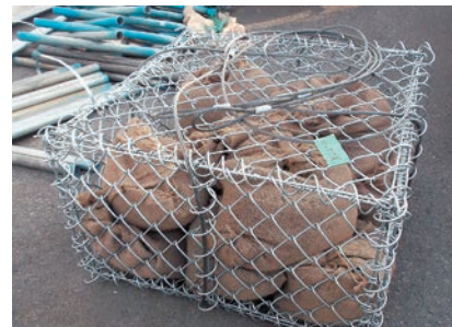
③ 網かごタイプ 腐植酸鉄供給ユニットを網かごに詰め、静穏海域に沈設。
