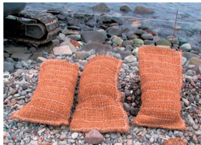
① ビバリーバッグ(ビバリーユニット) 転炉系製鋼スラグと人工腐葉土を混ぜ合わせた腐植酸鉄供給ユニットを海岸線に埋設。
