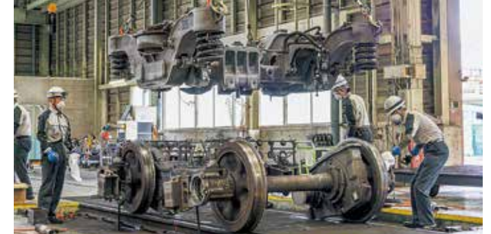
台車枠と輪軸を分離する
