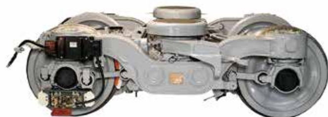
東京メトロ銀座線 1000系用操舵台車
