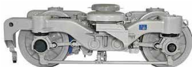
福岡市地下鉄空港線・箱崎線 4000系用操舵台車
