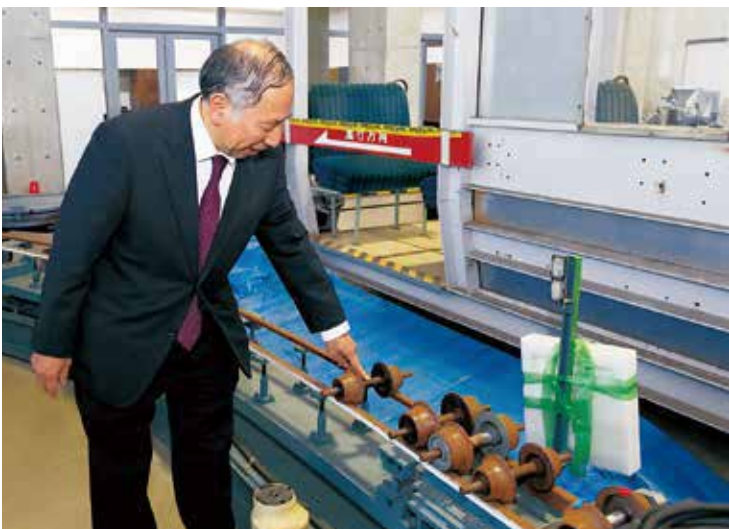
スケールモデル走行実験装置
