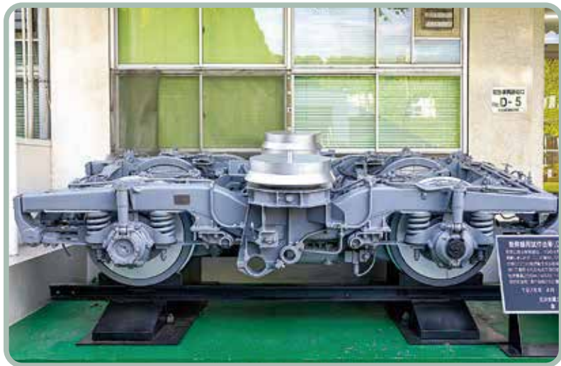
新幹線試作用DT9004台車
