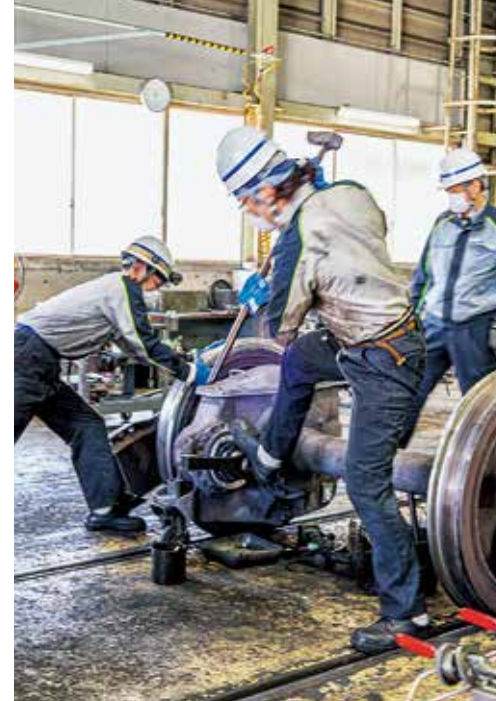
輪軸に取り付いている歯車装置をさらに分解する
