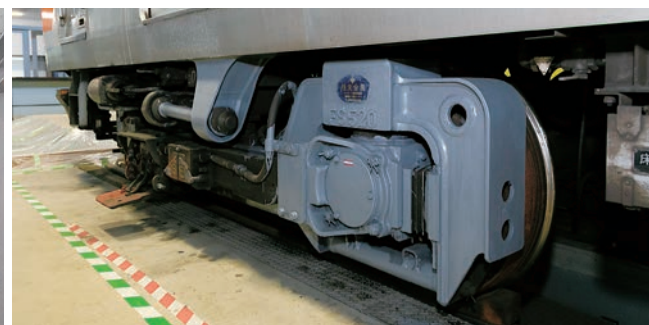
東京メトロから須田研究室に寄贈された銀座線01系 1984～2017年に運用されていた東京メトロ銀座線01系には、日本製鉄の関西製鉄所製鋼所地区で製造されたFS520ボルスタ付台車が採用されていた。
