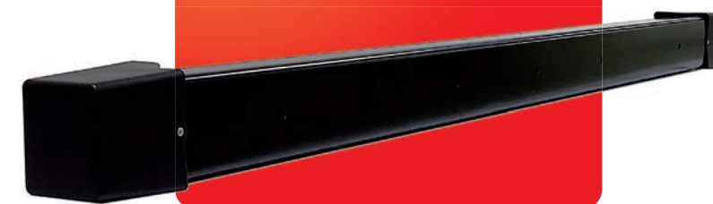
写真2 1180MPa級熱延ハイテン製の後部突入防止装置
