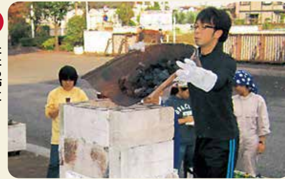
4 たたら炉に 砂鉄と木炭を入れる
