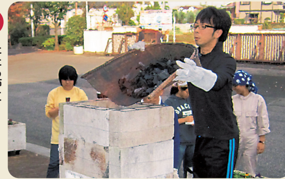
4 たたら炉に 砂鉄と木炭を入れる
