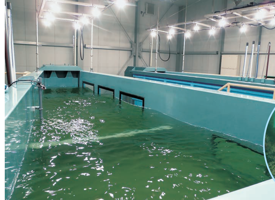
写真2 シーラボの実験水槽(海域環境シミュレーション設備)
