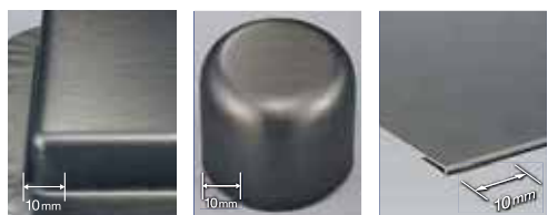
角筒絞り成形品 板厚：0.6mm 外径R：3.75mm 絞り高さ：15mm 円筒絞り成形品 板厚：0.6mm 絞り比：2.1 絞り高さ：36mm ヘミング曲げ成形品 板厚：0.6mm
