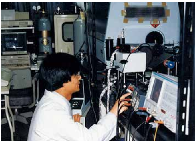
化学反応の瞬間を見るレーザーフラッシュフォトリシス実験
