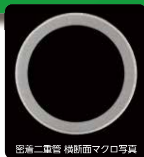
密着二重管 横断面マクロ写真
