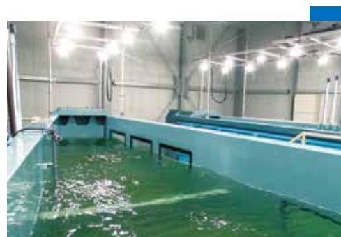
シーラボ(海域環境シミュレーション設備)では、製鉄の副産物である鉄鋼スラグを使った沿岸環境改善とCO 2 の吸収・固定(ブルーカーボン)について研究を進めている
