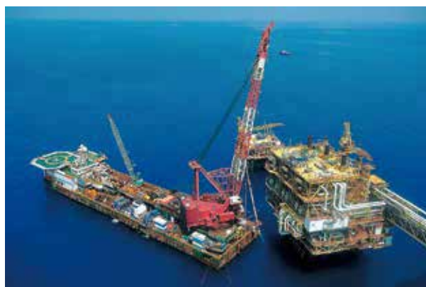
大型海洋作業船 左からくろしお、くろしお2。全周回大型クレーンを搭載、24時間施工が可能。
