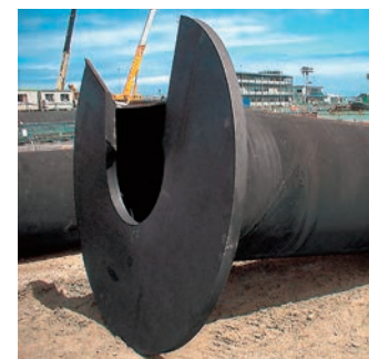
NSエコパイル® らせん状の羽根を先端に設けた鋼管を回転圧入する工法。羽根のくさび効果で地盤へのスムーズな貫入が可能。羽根の拡底効果により高い支持力を発揮します。
