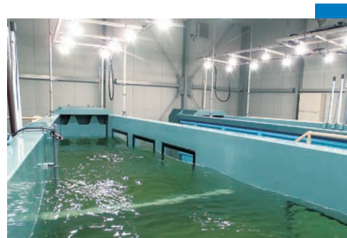
シーラボ（海域環境シミュレーション設備）では、製鉄の副産物である鉄鋼スラグを使った沿岸環境改善とCO 2 の吸収・固定（ブルーカーボン）について研究を進めている
