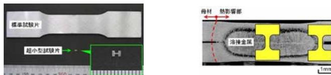
そこで、小型試験片（全長3mm未満、最小断面0.2mm角）の強度試験技術（引張試験・疲労試験）を新たに開発し、スポット溶接部の各領域の局所的な強度を直接測定することに成功しました。こうして取得した強度データを、溶接部材（溶接部を含む構造体）の強度・衝突シミュレーションに活用し、その精度向上に役立てています。さらに、これらの技術を用いて、溶接金属、熱影響部の強度が溶接部の強度に及ぼす影響を明らかにするとともに、得られた知見を新たな材料・溶接技術の開発に適用中です。一連の成果は、自動車各社様からも高い評価をいただいています。私たちはこれからも、独自の評価技術を駆使して、自動車の安全性向上に貢献していきます。
