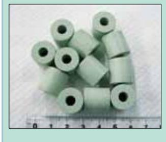
塞)を防ぐことと、硫化水素による触媒の劣化を低減することが大きな課題でした。炭素析出対策では触媒層を物理的に振動させて閉塞を防ぐ技術を開発し、硫化水素対策では触媒の成分設計の最適化を図り、劣化を抑える技術開発に成功しました(図4)(写真1)。
