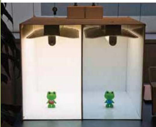
高反射タイプビューコート<sup>®</sup>(左)と一般照明用鋼板を用いた室内モデル。同じ明るさの蛍光灯でも室内の明るさに大きな違いがある。
