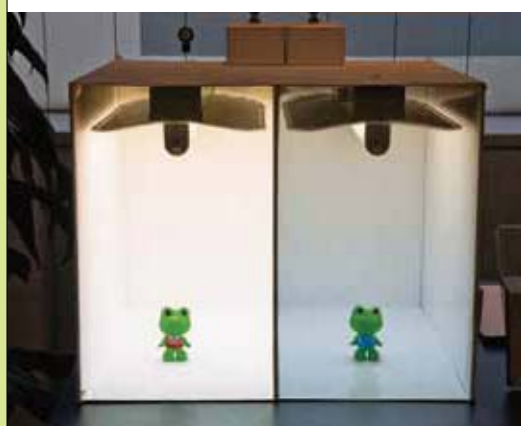
高反射タイプ ビューコート®(左)と一般照明用鋼板を用いた室内モデル。同じ明るさの蛍光灯でも室内の明るさに大きな違いがある。
