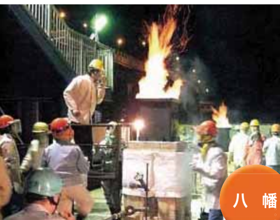
砂鉄の代わりに微粉鉄鉱石を使用したり、砂鉄に銅を配合して鉄への色付けに挑戦
