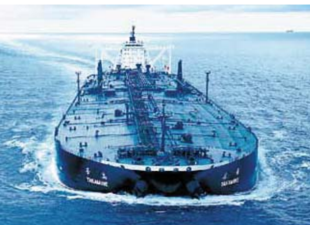
NSGP-1 を初めて採用した原油タンカー「TAKAMINE」 (2004年 VLCC 載貨重量約 30 万トン 全長 333m × 幅 60m)
