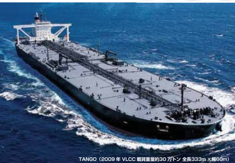
TANGO (2009 年 VLCC 載貨重量約30 万トン 全長333m ×幅60m)
