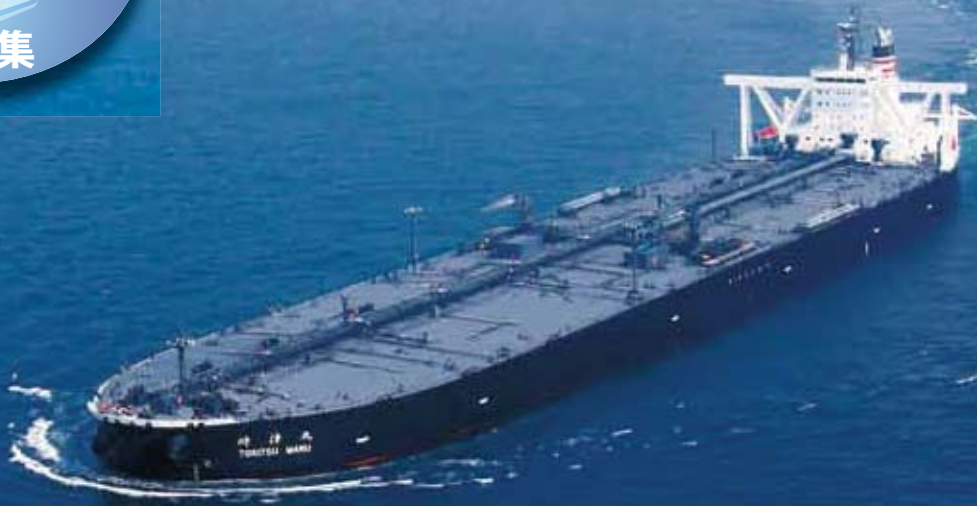
時津丸 (2011 年 VLCC 載貨重量約30 万トン 全長324m ×幅60m)
