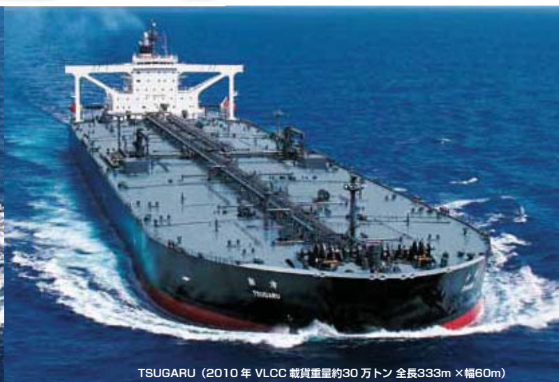
TSUGARU (2010 年 VLCC 載貨重量約30 万トン 全長333m ×幅60m)
