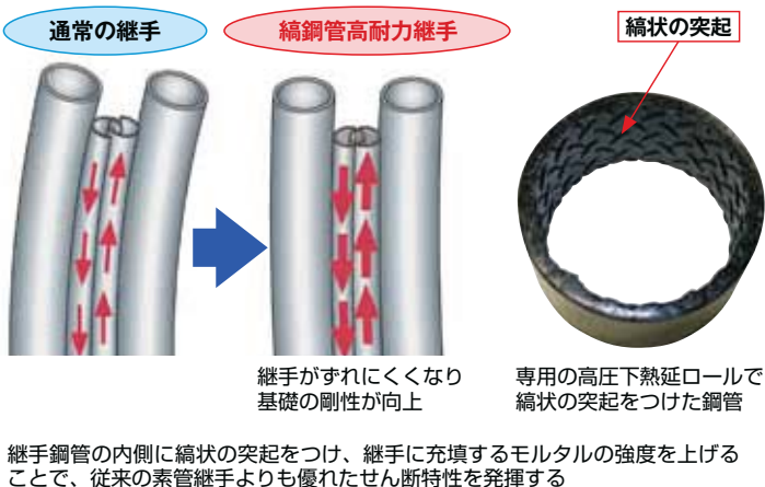
図5 せん断のメカニズム
