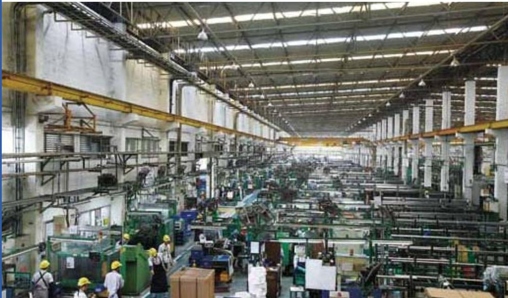
自然光を採り入れた屋根構造で作業環境改善と省エネルギーを両立。写真は50台以上の精密切断機が並び、月当たり700万本以上の鋼管を切断する切断棟
