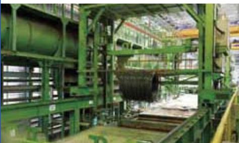
スケール除去と表面潤滑処理を行う酸洗工程
