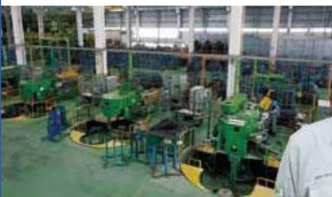
寸法精度・機械的特性を高める伸線機
