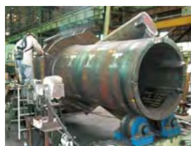
ゲイン塔（PHY700PB 鋼管）製作状況 写真提供：（株）バコーボレーション
